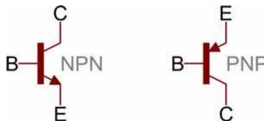
Os símbolos de circuito para o NPN e os transístores PNP
